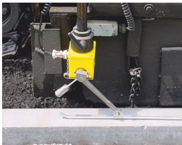
G176 plus сканирование поверхности
